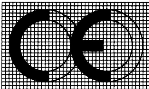
A marcação CE deve ter uma altura de, pelo menos, 5 mm e, se for reduzida ou ampliada, devem ser respeitadas as proporções que figuram no desenho graduado acima.
