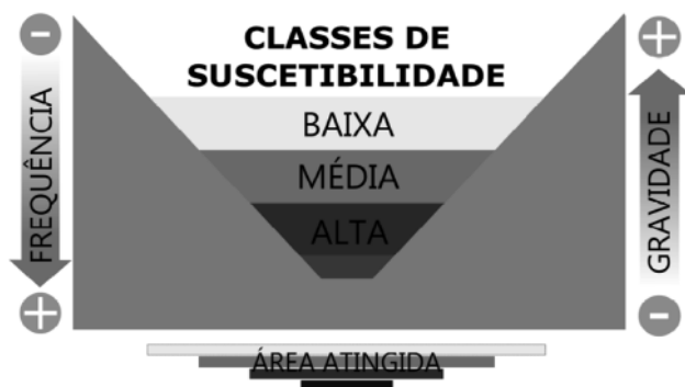
Figura 27 Relação das classes de suscetibilidade com a frequência de ocorrência (probabilidade), a sua potencial gravidade e a área atingida pelas cheias.
